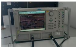
Analizador de microondas portátil hasta 14GHz / fijo 40 hasta GHz.
