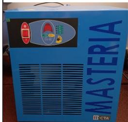
Equipo que permite reducir de forma notable el contenido de vapor de agua o humedad en el aire comprimido.
