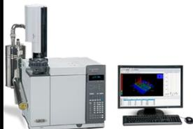
La cromatografía de gases (GC) es una técnica analítica que se utiliza para separar y analizar compuestos volátiles de una mezcla. Se utiliza como fase móvil un gas que arrastra los diferentes componentes de la muestra a través de la columna cromatográfica donde son separados por la combinación de diversos procesos de interacciones físicas y/o químicas entre los componentes de la muestra y la fase estacionaria.
