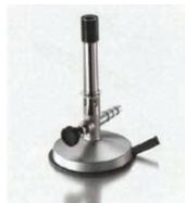
Es un quemador de gas natural o GLP. La llama se regula en función de la mezcla de aire y combustible.
