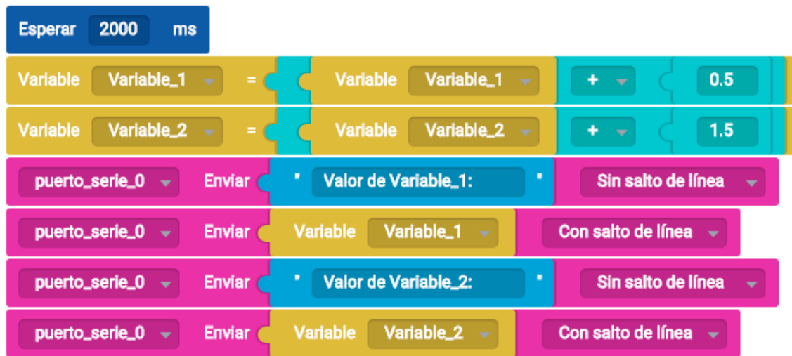
Figura 1.2.6-4. Programa en BitBloq para enviar los valores de 2 variables por puerto serie.
