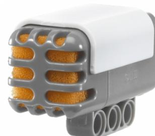
Vamos a realizar un programa para que, cuando detecte un ruido fuerte, el robot aplauda (con el altavoz, claro). Para ello, en primer lugar conectamos el micrófono al puerto 1 de los sensores y, a continuación creamos el programa que se ve en la figura.
